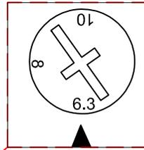
Calibrer le disjoncteur en fonction de la puissance de la pompe
